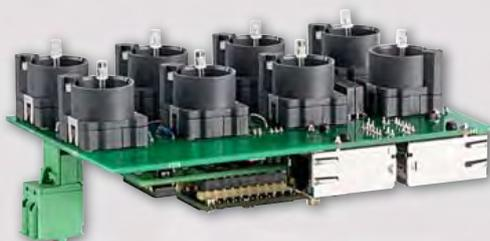
Spécification Profinet I/O: 2 ports avec transformateur
