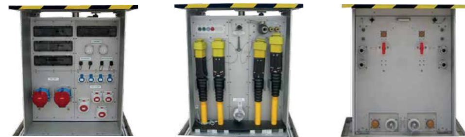
Flughafen-Senkelekrant SE100 400 Hz Technik 50 Hz Installationsgeräte Niederspannungsstrom Datennetz Druckluft Frischwasser Abwasser
